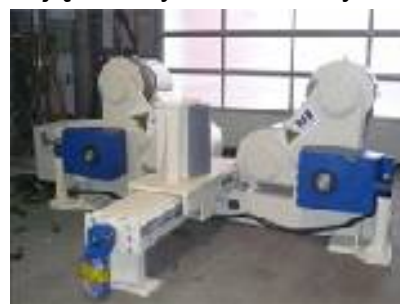
Obrotnik z regulowaną prędkością, zadawaną z panelu przez operatora lub przez robota
