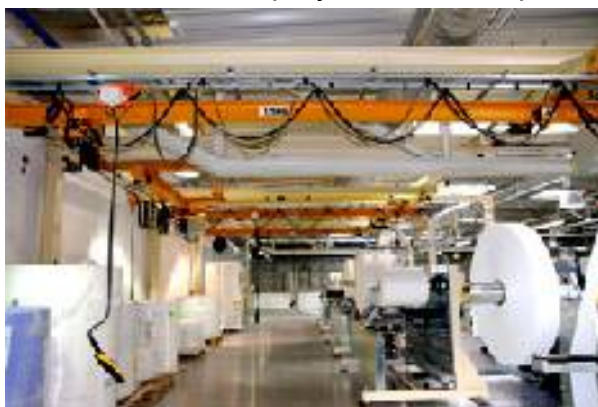
Suwnice podwieszane kasetami sterowniczymi zamontowanymi niezależnie od wciągarki
