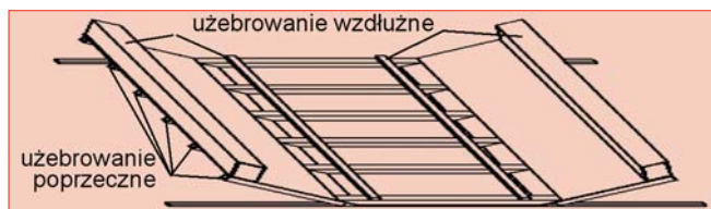
Rys. 2 Ustrój pomostowy o konstrukcji powłokowej [3]
