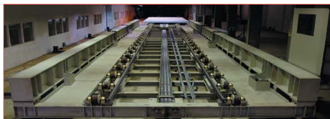
Rys. 4 Ustrój pomostowy przesywnicy technologicznej Q = 90 t o konstrukcji rusztowej [4]
